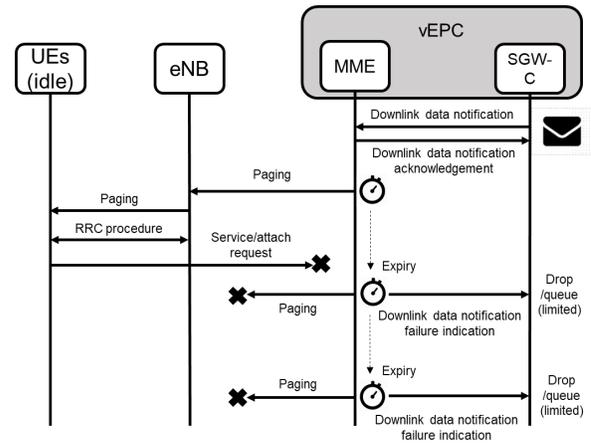
Fig. 3: vEPC paging failure
